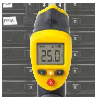
红外测温仪，一个点的温度测量
