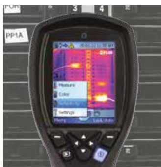
FLIR i3，3,600个点的温度测量
