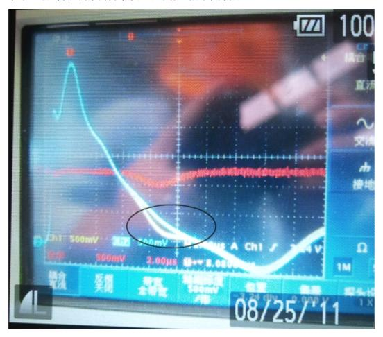
某厂氢冷式发电机转子 RSO 波形测试图
